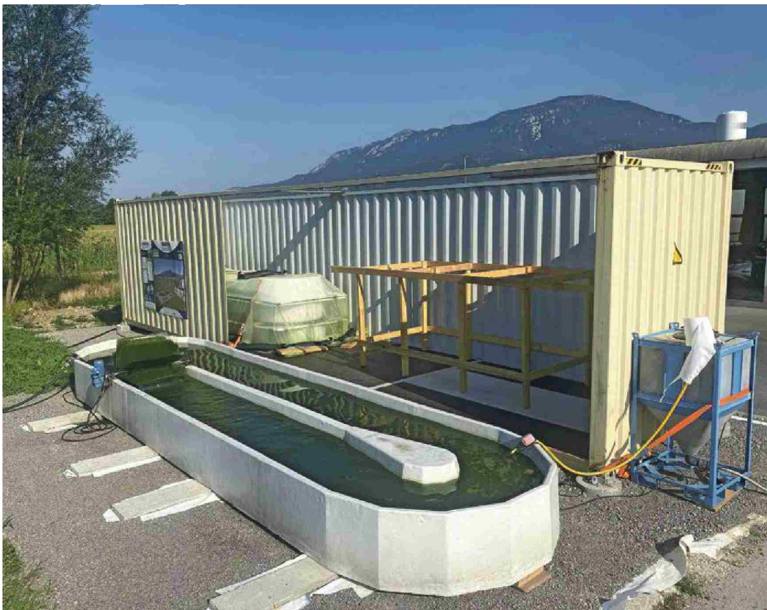
Pilotni algni reaktor na poligonu zelenih tehnologij v okviru centralne čistilne naprave Ajdovščina, kjer se zelene tehnologije za izboljšano čiščenje odpadne vode, kot so rastlinske čistilne naprave, vrtni in algni sistemi, razvijajo že več kot desetletje. FOTO NATAŠA ATANASOVA
