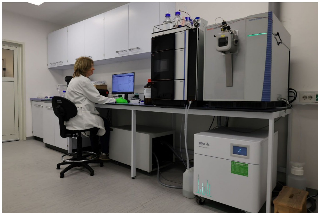
Orbitrap Exploris 240 masni spektrometer sklopjen s tekočinskim kromatografom je hibridni masni spektrometer tipa kvadrupol - Orbitrap.
